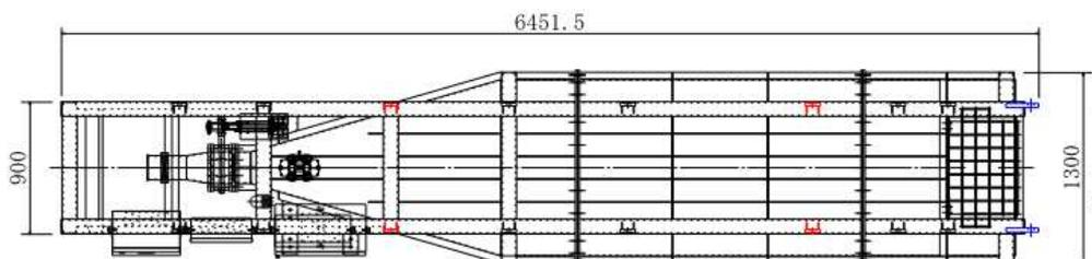
**4.0m³コンクリートホッパーホッパー総重量 約1.94 t (内部空状態)**
