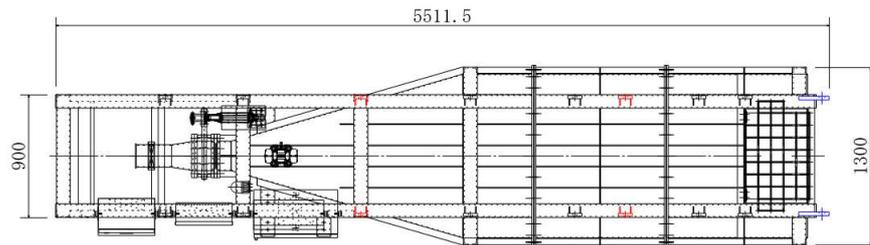
**3.0m³コンクリートホッパーホッパー総重量 約1.72 t (内部空状態)**
