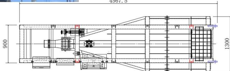
**2.0m³コンクリートホッパーホッパー総重量 約1.40 t (内部空状態)**
