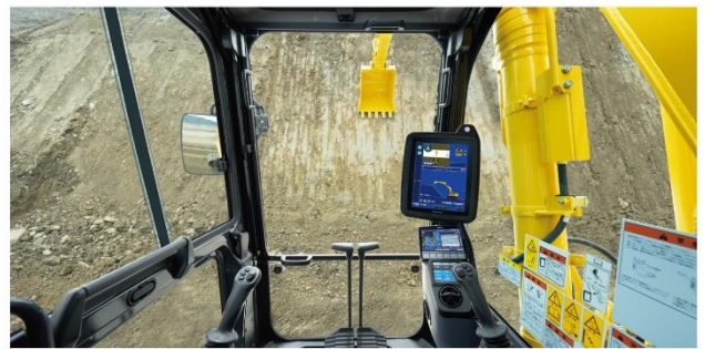
マルチGNSSに対応しさらに進化したインテリジェントマシンコントロール
