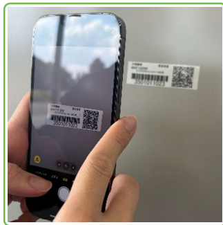
2.バーコード読込 点検表起動、点検開始
